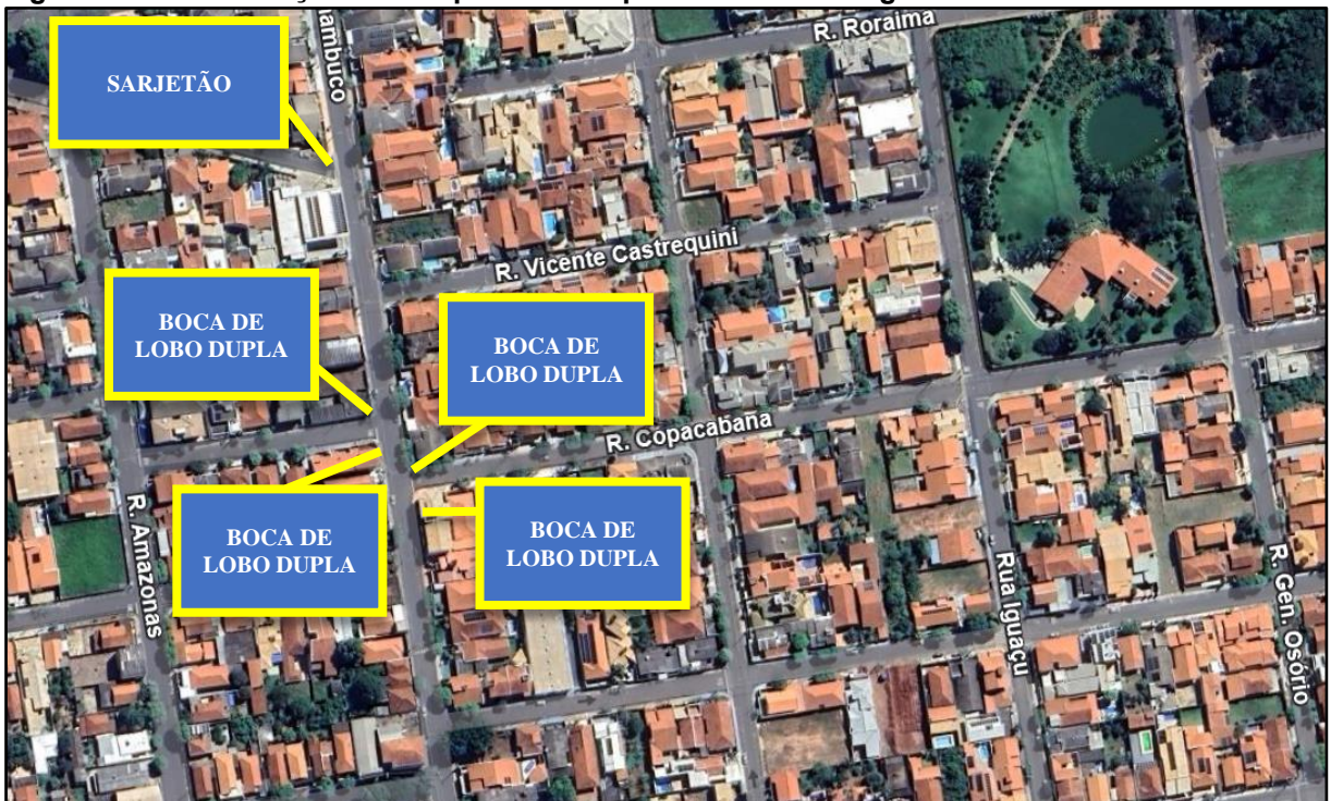
Figura 237: Identificação dos dispositivos superficiais de drenagem da Área 4
