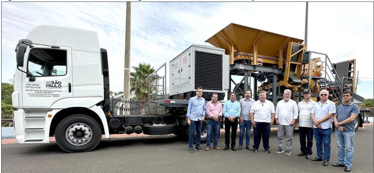
Figura 313: Usina móvel de Reciclagem de Resíduos da Construção Civil
