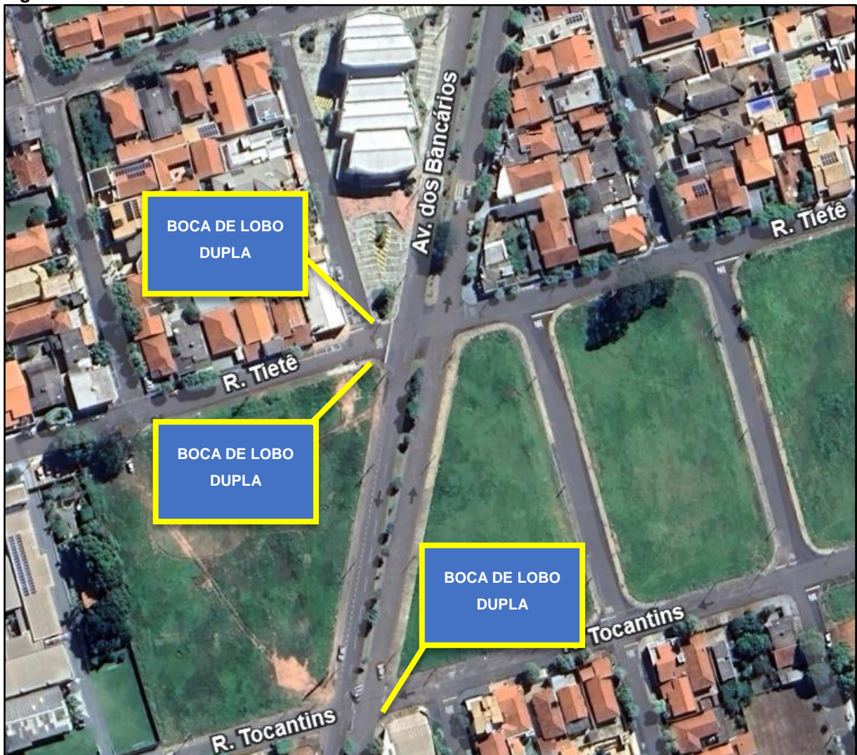
Figura 231: Bocas de lobo existentes na Area 1
