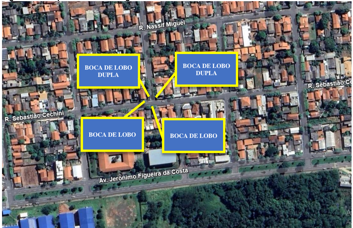
Figura 240: Dispositivos de drenagem existentes na Área 6
