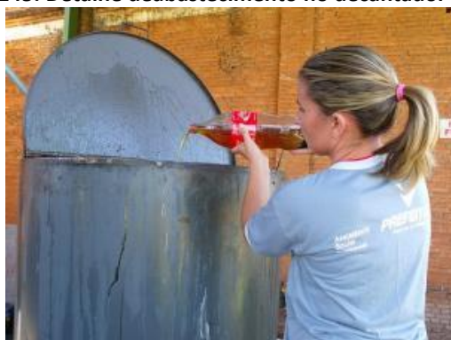
Figura 145: Detalhe de abastecimento no decantador de óleo.
